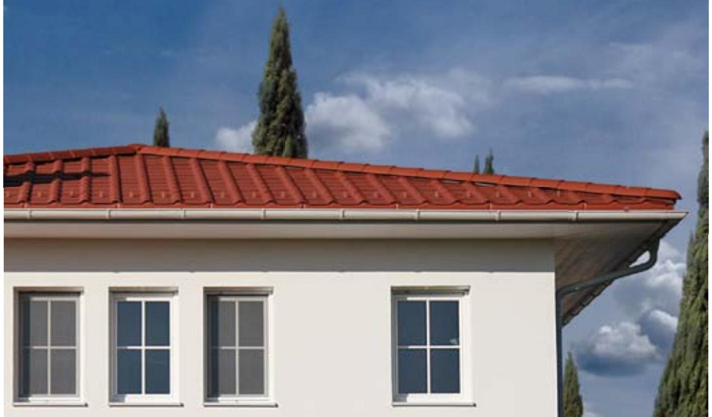
Die Toscana Dachplatte überzeugt durch ihre fließende Optik und ist bereits ab einer Dachneigung von 10° voll einsetzbar. 2-fach mit dem Unterdach verschraubt, bietet sie beste Sturm- und Schneelastsicherheit. Erhältlich im Format 1166 x 625 mm und 4 Farben.
